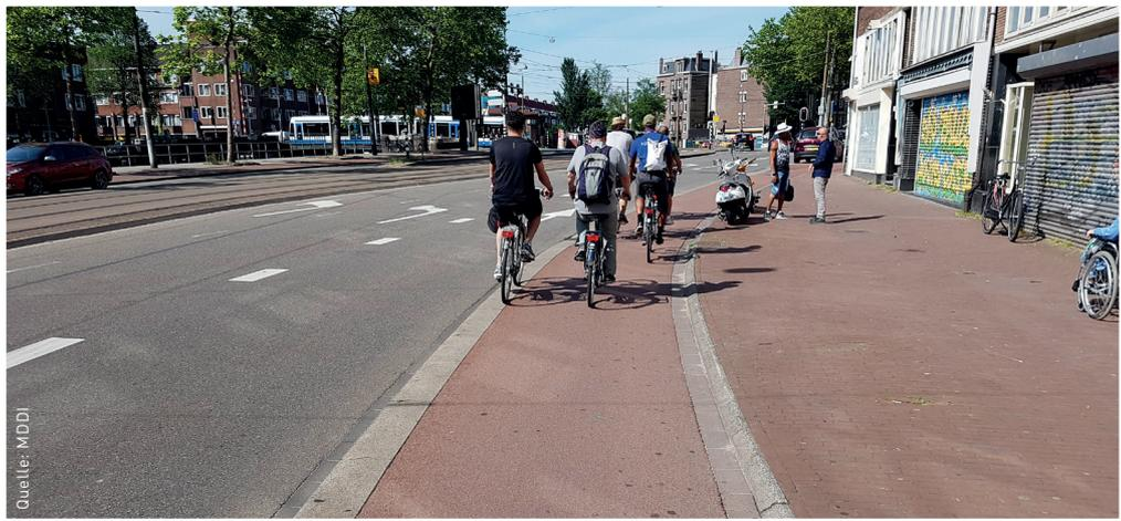
Der Radweg ist auf Fahrbahnniveau angelegt und baulich mittels Bordsteinen, Betonleitwänden, oder Ähnlichem vom Kfz-Verkehr und vom Gehweg getrennt.
