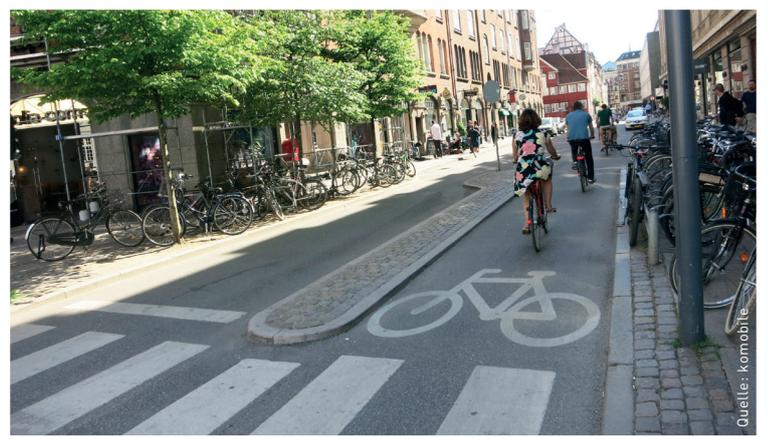
Durch das Schild A,12 – „Débouché de cyclistes“ mit dem Zusatz „Modèle 6e“ und einer entsprechenden Bodenmarkierung mit Pfeilen in beiden Richtungen kann dem Kfz-Verkehr bei Einmündungen der Zweirichtungsverkehr des Radverkehrs zusätzlich verdeutlicht werden.
